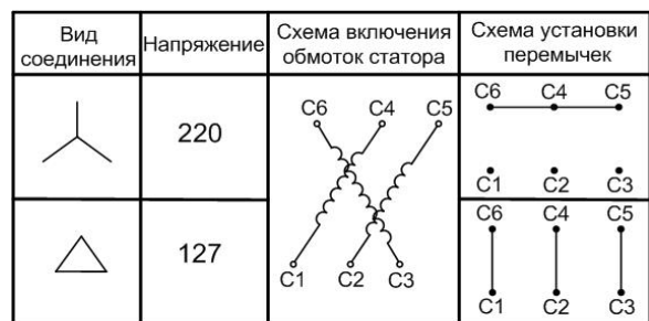
Рис. 2. Схема соединений обмоток электродвигателя переменного тока
