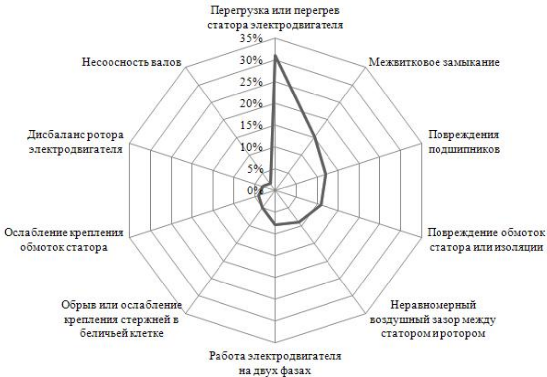
Рис. 6. Соотношение наиболее распространенных видов неисправностей асинхронных электродвигателей
