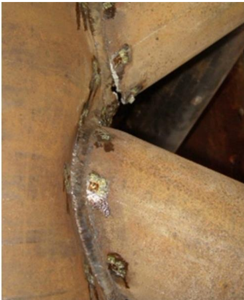
Рис. 8. Режим руйнування розкосів у порожнистих вузлах: a – за дослідженням Венцзін Хуана та ін. [16]; b – зразка D40–16D у масштабі 1:1
