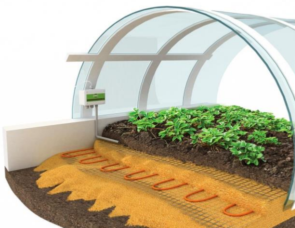
Рис. 1. Електрична система опалення теплиці https://eco-obogrev.com
