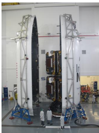
Рис. 2. Розташування супутника (корисне навантаження) у середині головного обтічника
