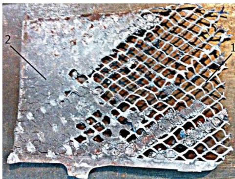
Рис. 3. Акумуляторна пластина: 1 – свинцеві ґрати; 2 – сульфатно-оксидна складова
