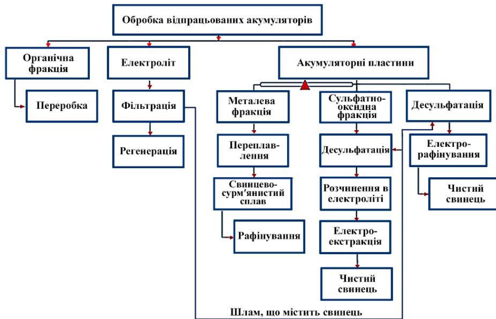
Рис. 1. Схема переробки свинцево-кислотних акумуляторів: червоним трикутником позначено операцію подрібнення акумуляторних пластин
