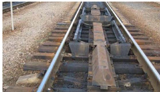
Рисунок 1 – Технические средства для закрепления подвижного состава на станционных путях: а - УТС-380; б - АСУЗР-65.
