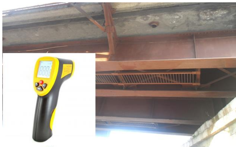
Рисунок 2.5 – Процесс экспериментальных измерений распределения температуры на вертикальных поверхностях сталежелезобетонного пролетного строения железнодорожного моста
