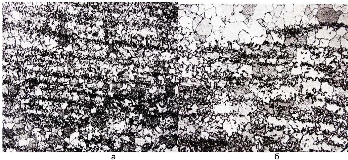
Рисунок 8 - Вплив ТЦО у водні на вихідну строчковість сталі (0,23%С), \times 100 : а – 5 циклів, б – 10 циклів
