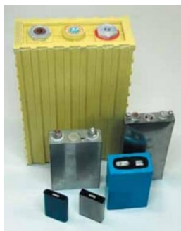
Рисунок 1.8. Призматичні Li-ion акумулятори
