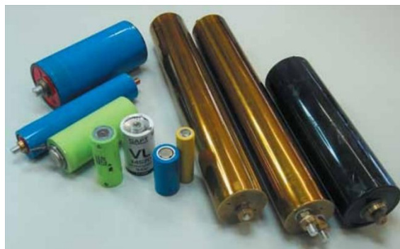
Рисунок 1.7. Циліндричні Li-іон акумулятори
