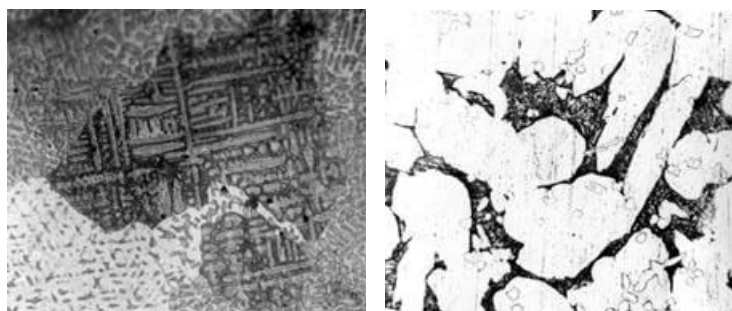
Рисунок 5.4- Однофазна (а) та двофазна (б) бронзи
