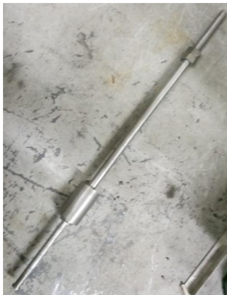
Рис. 3.8. Ударник ДорНДІ, що використовується для вимірювання ущільнення ґрунту – фото ударника
