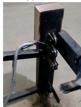
Рис. 3.6. Механізм приводу, та відхиляючі ролики
