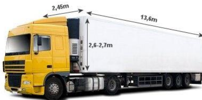
Рисунок 5.4 – Розміри стандартного напівпричепу
