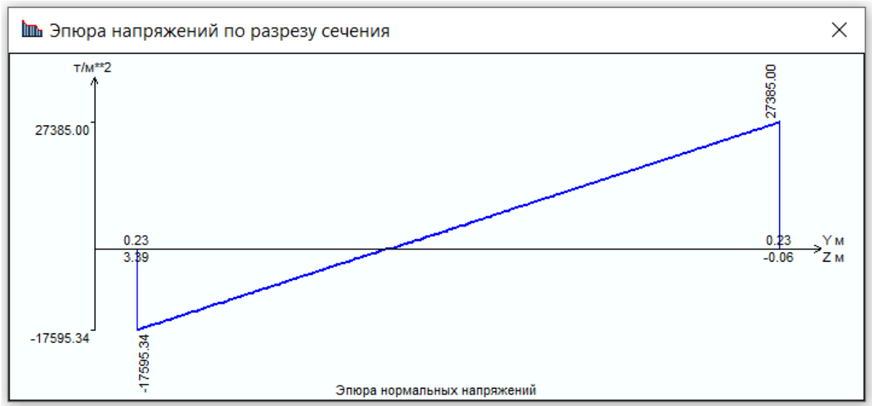
Рис. 2.20 – Еюра напружень по розрізу перерізу ( \text{т/м}^2 )
