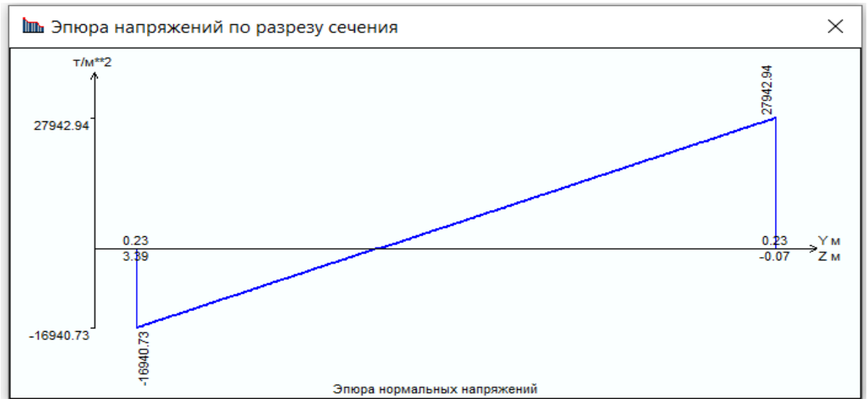
Рис. 2.22 – Епюра напружень по розрізу перерізу ( \text{т/м}^2 )
