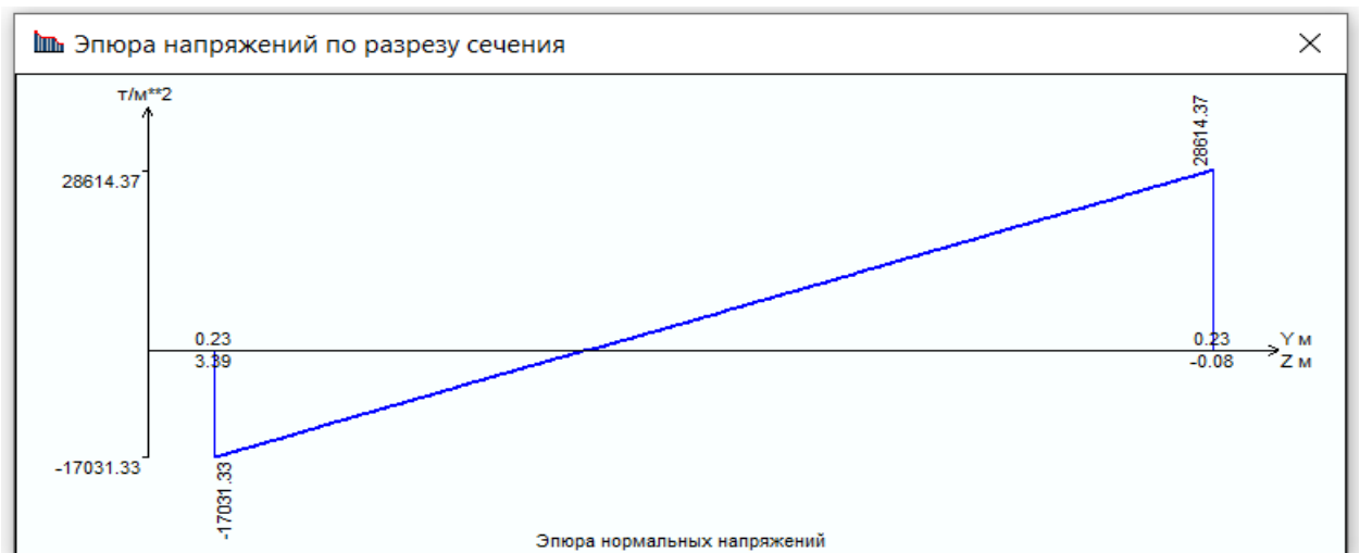
Рис. 2.24 - Епюра напружень по розрізу перерізу ( \text{т/м}^2 )
