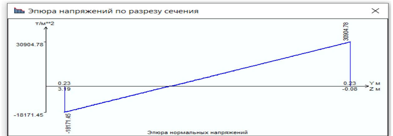
Рис. 2.9 – Епюра напружень по розрізу перерізу ( \text{т/м}^2 )
