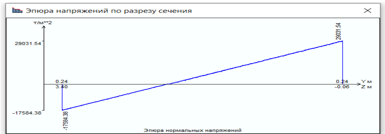
Рис. 2.26 - Епюра напружень по розрізу перерізу (т/м 2 )
