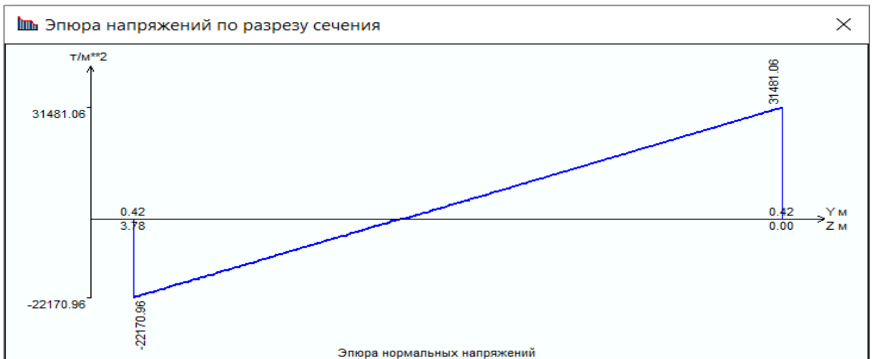
Рис. 2.37 - Епюра напружень по розрізу перерізу ( \text{т/м}^2 )
