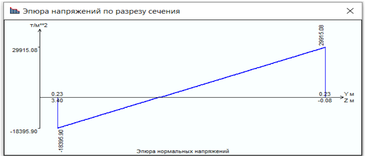
Рис. 2.28 - Епюра напружень по розрізу перерізу ( \text{т/м}^2 )
