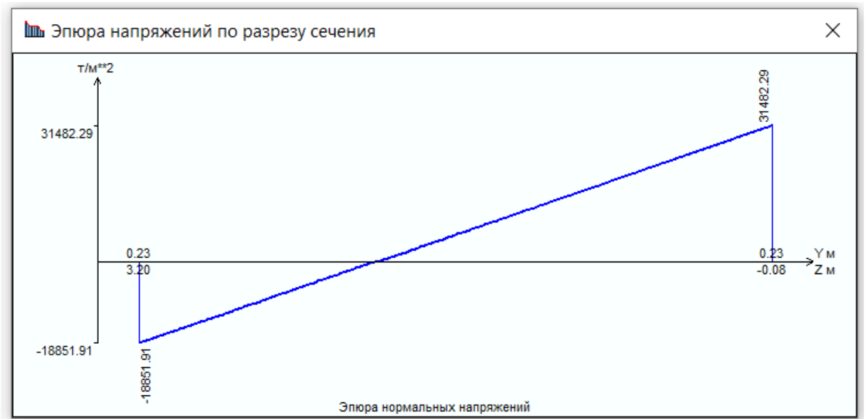
Рис. 2.11 – Епюра напружень по розрізу перерізу ( \text{т/м}^2 )
