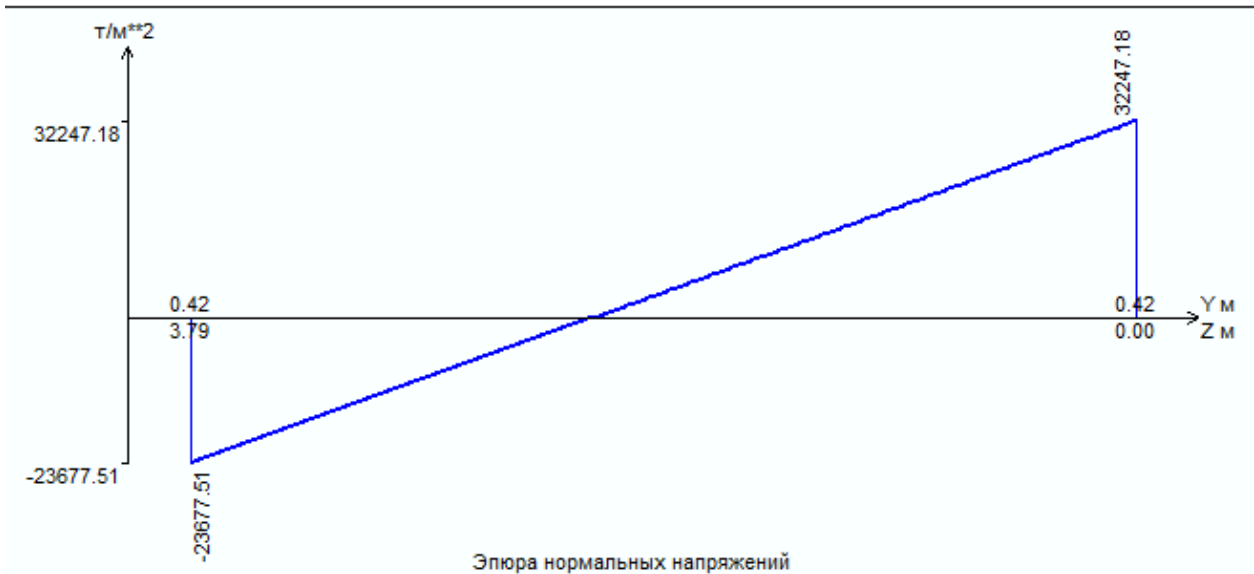
Рис. 2.39 - Епюра напружень по розрізу перерізу ( \text{т/м}^2 )
