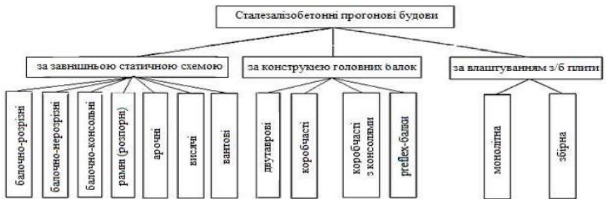
Рис. 1.2 – Різноманітність сталезалізобетонних прогонових будов
