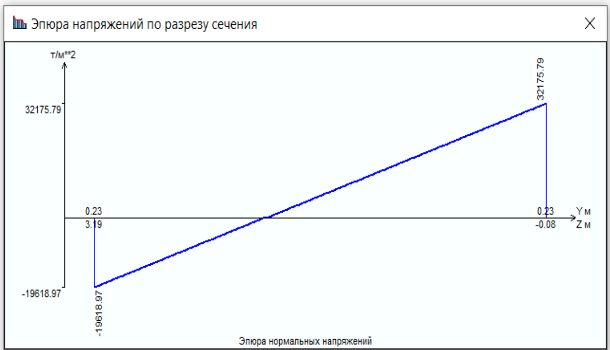
Рис. 2.13 – Епюра напружень по розрізу перерізу ( \text{т/м}^2 )
