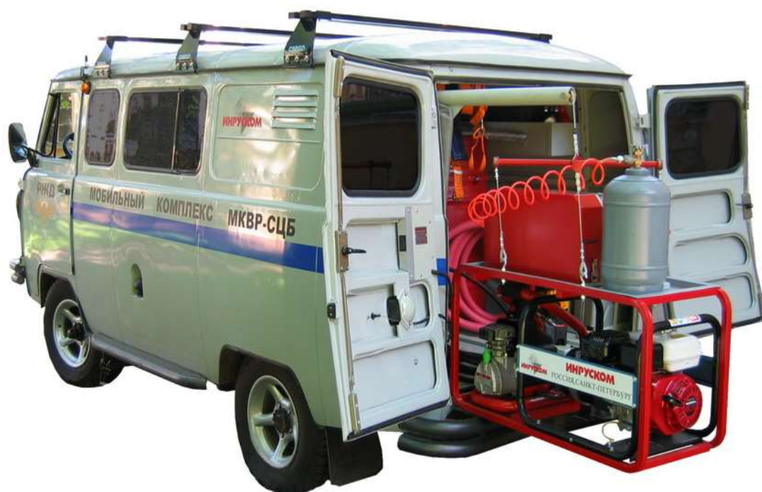
Рис. 1.6. а) Робоче обладнання мобільного комплексу СЦБ ( МКВР–СЦБ )
