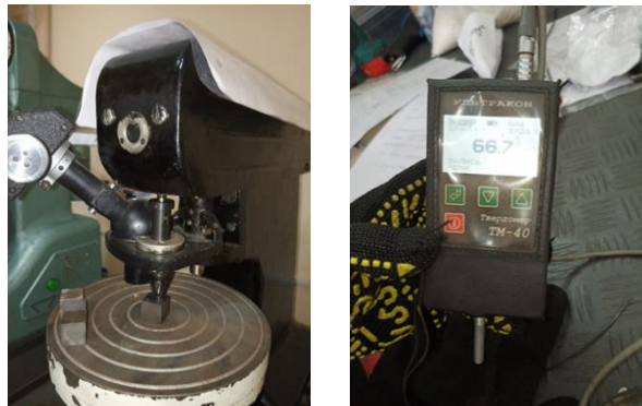
Рис. 6. Замір твердості експериментальних зразків інструменту (м.Суми, ТОВ «Карбаз»)
