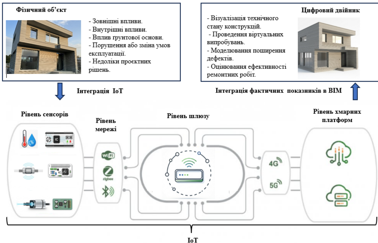
Рис. 3. Трансформація будівельної інформаційної моделі в цифрового двійника
