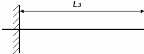
Рис. 1. Розрахункова модель опори для визначення власної частоти
