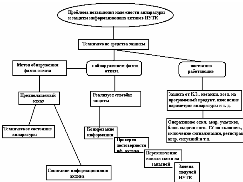
Рис. 3. Семантическая схема проблемы повышения надежности аппаратуры и защиты информационных активов с помощью технических средств с позиций причинно – следственной иерархии
