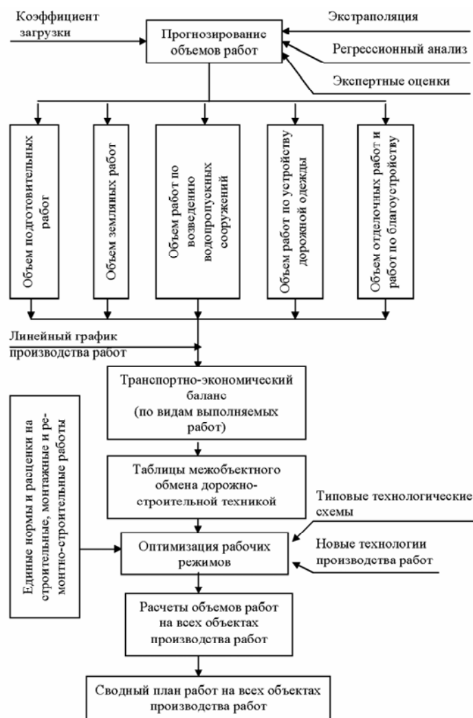
Рис. 4. Порядок планирования транспортного дорожно-строительного логистического потока
