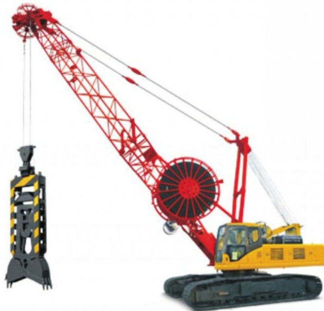
Рис. 2.3.1 Грейферний екскаватор SANY SH350D
