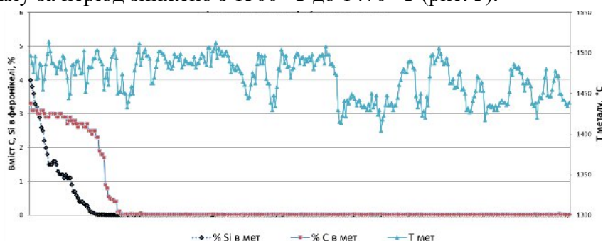
Рис. 3. Зміна сорту феронікелю під час переходу з технології високого відновлення заліза на технологію низького відновлення
