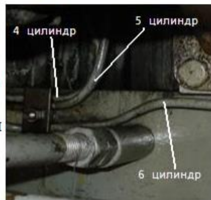
Температура довкільля +20°C, несправний ПНВТ: 6 циліндр дизеля - знос плунжерної пари
