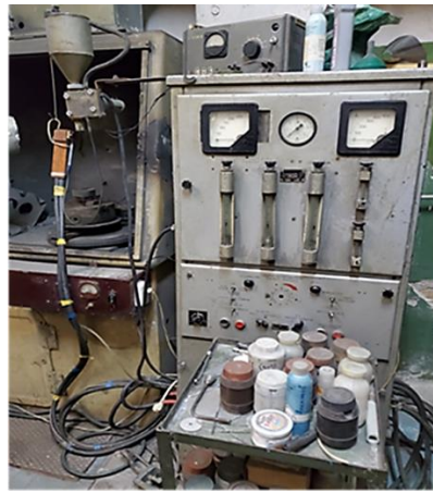
Рисунок 4 - Установка УПУ-3Д з плазмотроном ПП-25 і порошковим дозатором
