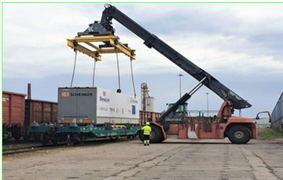
Рис. 5.27 – Процес навантаження і вивантаження за допомогою річкастера
