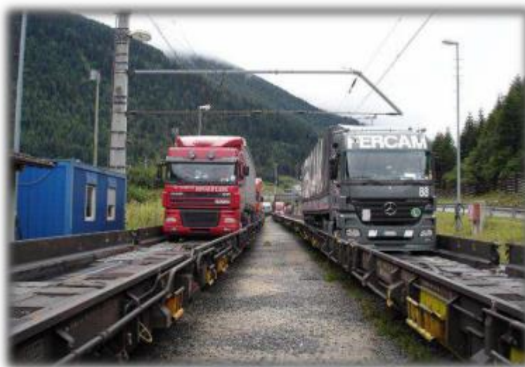
Рисунок 5.7 – Контрейлерна технологія Ro-La «Біжуче шосе»
