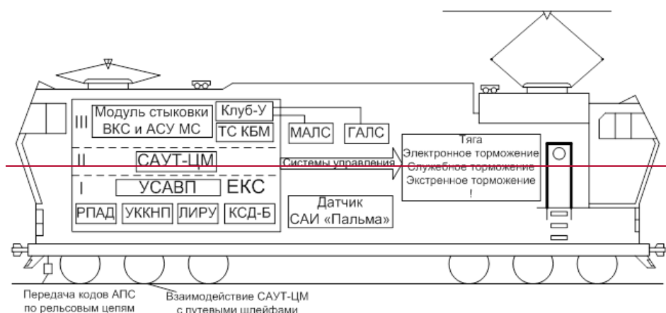
Рис. 3.1. Система автоматичної локомотивної сигналізації локомотива.
