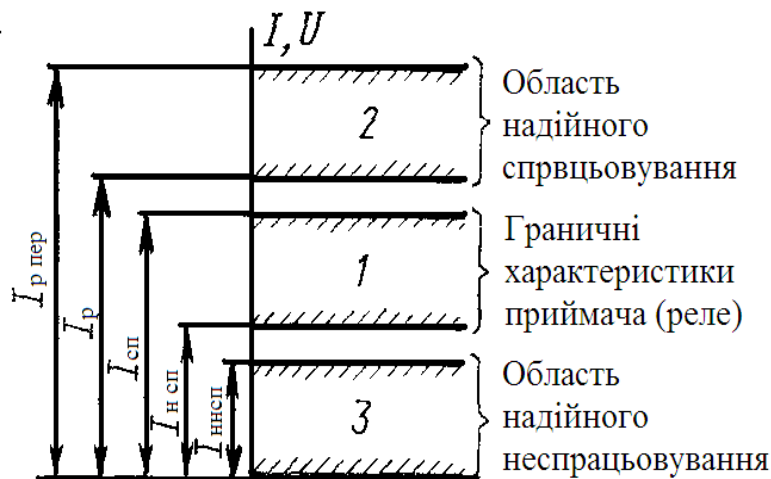
Рис.4.2. Граничні значення характеристик колійних приймачів в різних режимах роботи рейкового кола
