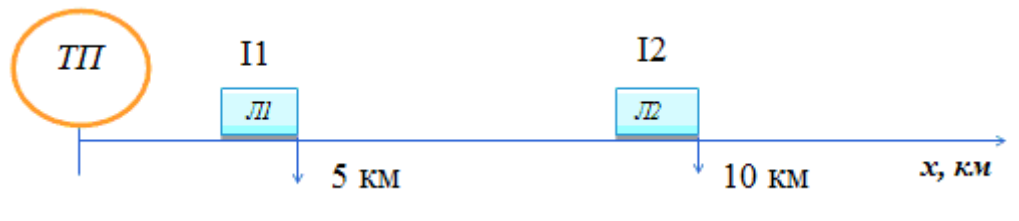
Рис. 3.1. Схема розташування локомотивів (поїздів) на фідерній зоні з однобічним живленням
