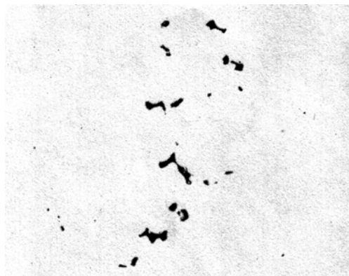
Рисунок 4.1 – Структура виливного колеса (а – макроструктура, б – несущість). Збільшення б – 100 разів.
