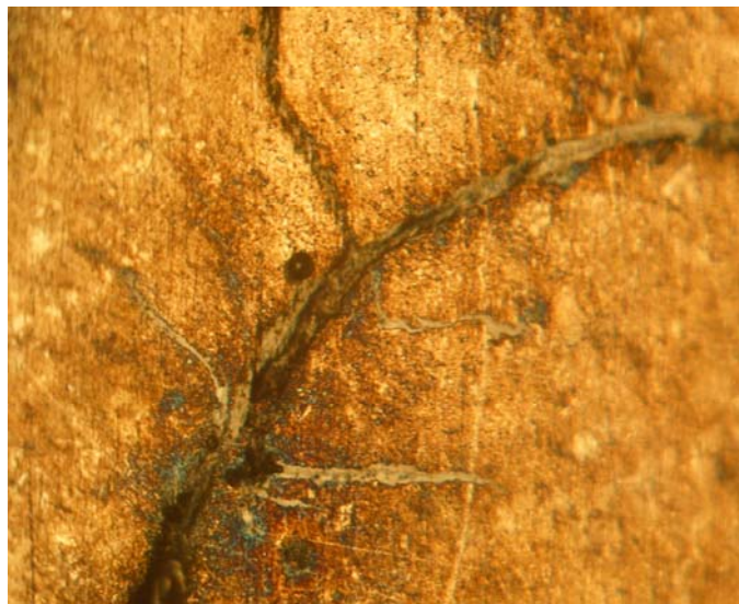
Рисунок 5.16 – Схематичне зображення сформованих кільцевих тріщин, які паралельні поверхні кочення (а), реальний їх вигляд в ободі колеса (б), Вигляд тріщини на поперечному темплеті обода колеса (в), мікроструктура металу з тріщиною, яка заповнена окислами (г). Збільшення г – 200.
