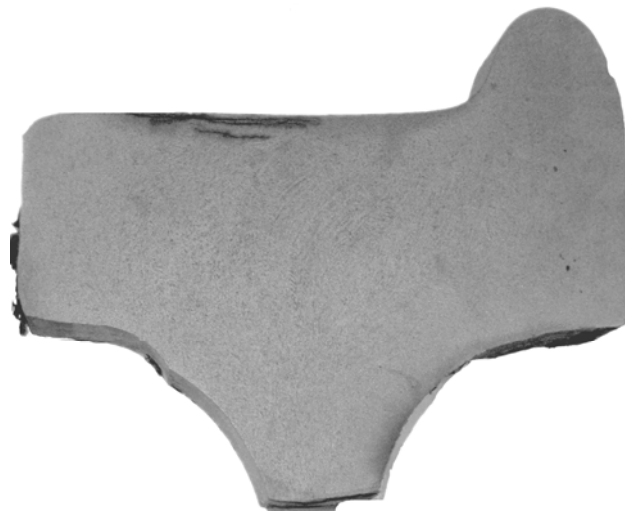
Рисунок 5.4 – Перетин обода колеса. Розповсюдження тріщини уздовж поверхні кочення колеса.
