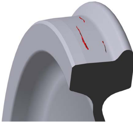
Рисунок 5.9 – Схематичне зображення повздовжніх тріщин по поверхні кочення залізничного колеса.
