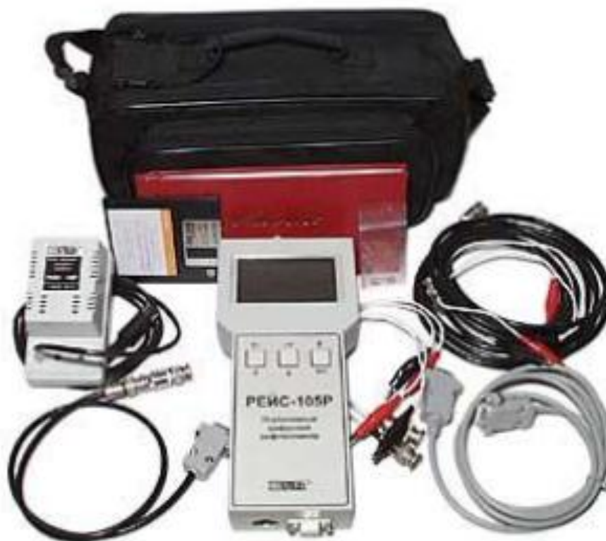
Рисунок. 3.1 – Комплект приладу РЕЙС-105Р
