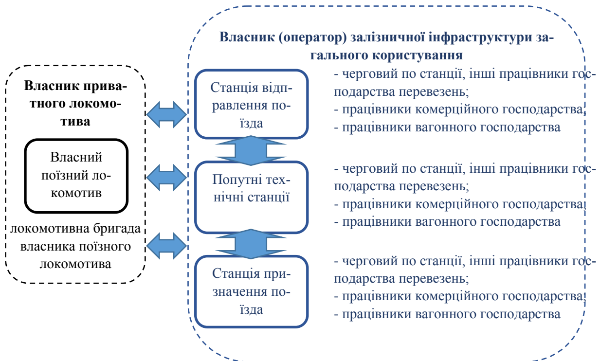
Рис. 1. Структурно-логічна схема технологічного процесу взаємодії власника приватних локомотивів та підрозділів власника інфраструктури загального користування
