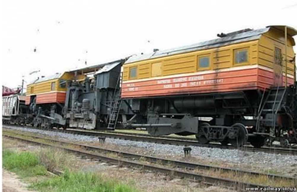
Рисунок 4.3 – ВПО-3000 виправно-підбивочно-рихтувальна машина безперервної дії
