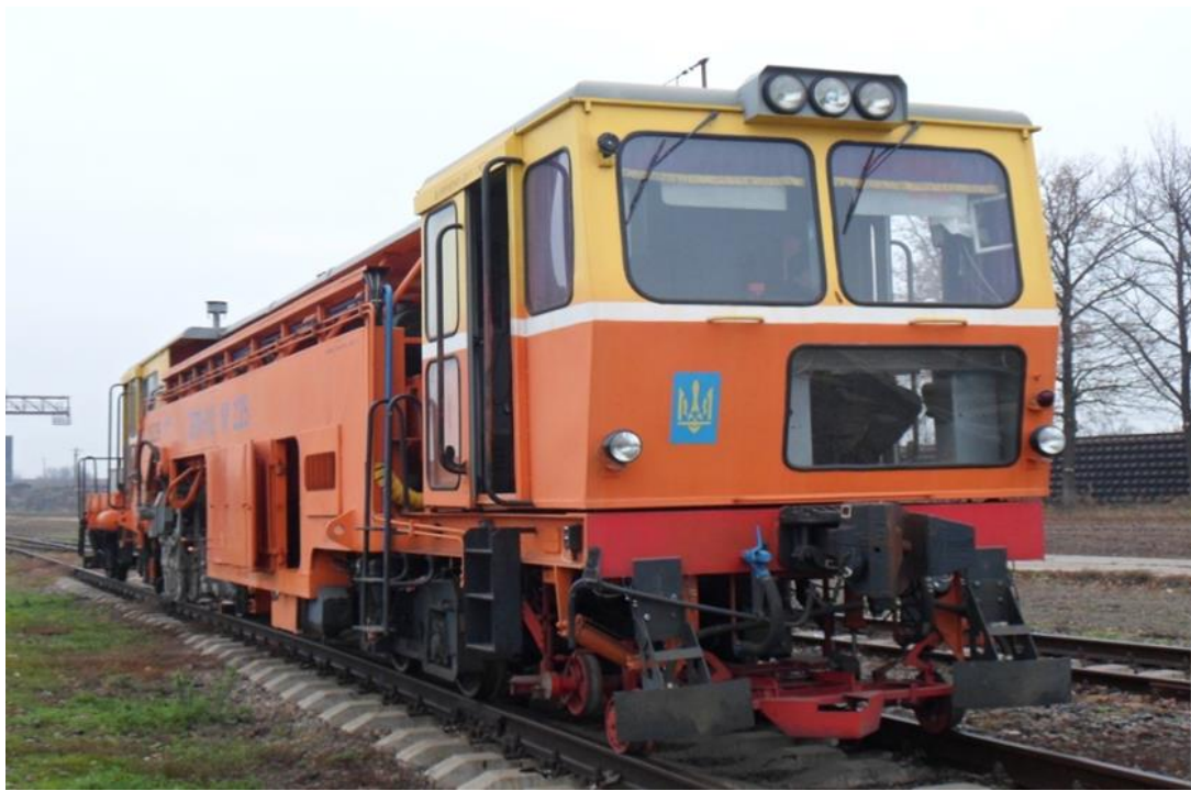
Рисунок 4.2 – ВІР-02 – Машина обладнана мікропроцесорною системою керування виправкою колії
