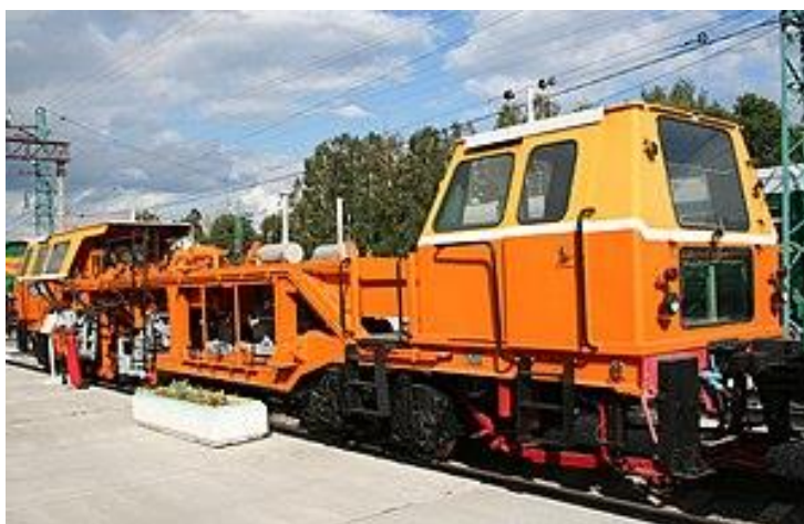
Рисунок 4.1 – ВПР-1200 виправно-підбивочно-рихтувальна машина циклічної дії
