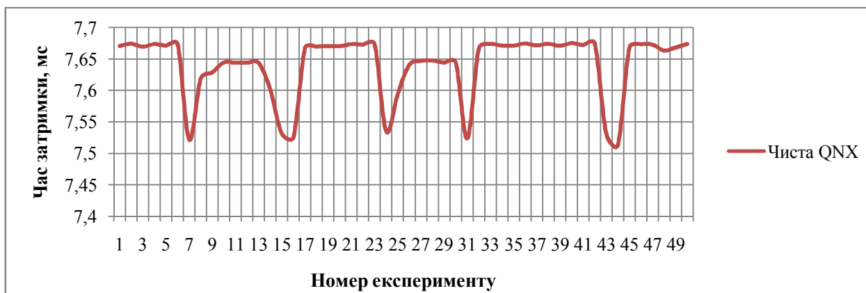
Рисунок 4.5 — Збільшений частковий графік отриманих часових даних для переривань миші для «чистої» QNX, мс
