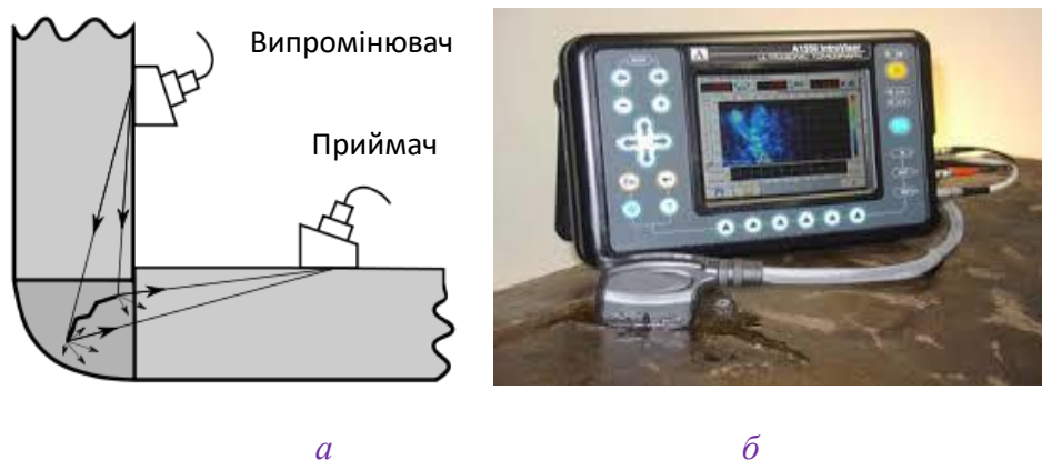
Рисунок 1.47 – Схема поширення ультразвукових хвиль у матеріалі з внутрішніми дефектами (а) [12] та одна з товарних моделей ультразвукового дефектоскопа (б) [1]
