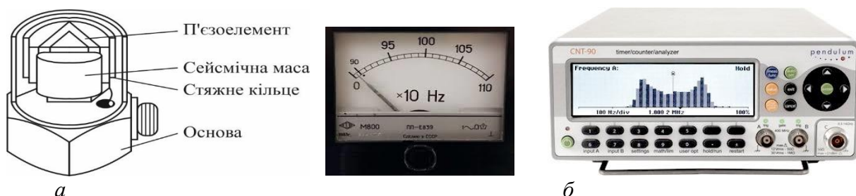
Рисунок 1.16 – Схема п'єзодатчика вібрації (а) та приклади вимірювальних приладів віброметрів [1]
