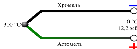
Рисунок 1.13 – Схема хромель-алюмелевої термопари
