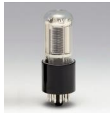
Рисунок 1.51 – Фотоелектронний помножувач: а – схема; б – вигляд товарного виробу [5]
