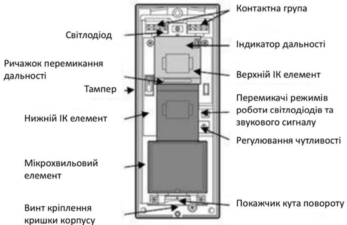
Рисунок 2.6 – Принцип роботи комбінованого датчика руху
