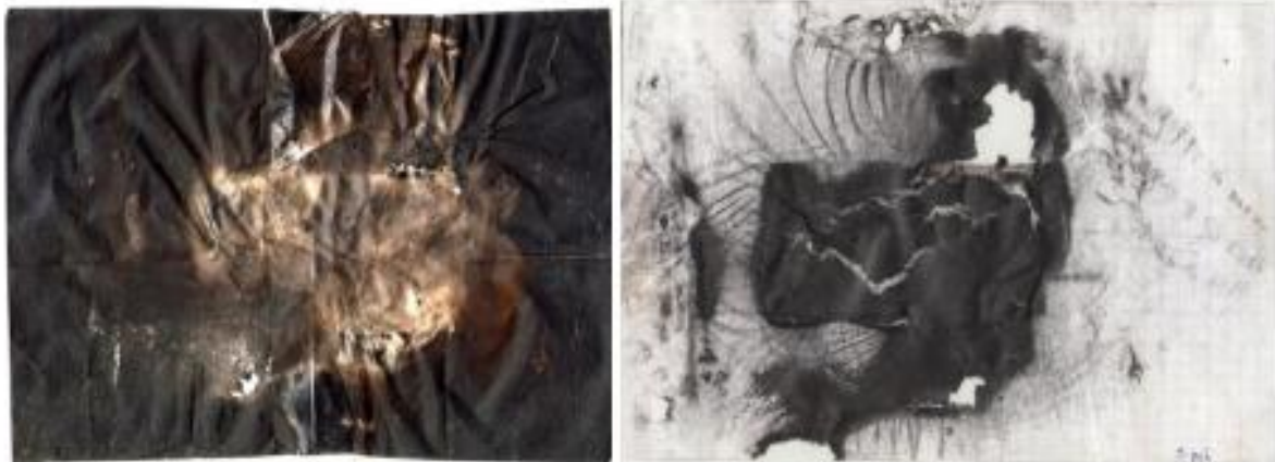
Рисунок 3 – Відбиток плями контакту при ударі хвостовика об упорну плиту вантажного вагону (напіввагону)
