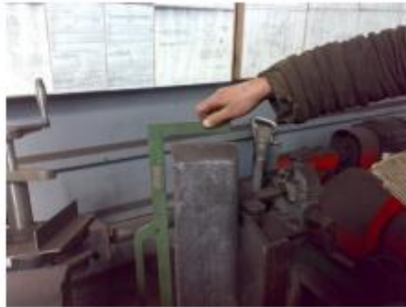
Рисунок 2 – Визначення зносу шаблоном корпусу автозв'язу електровозу ЧС 2
