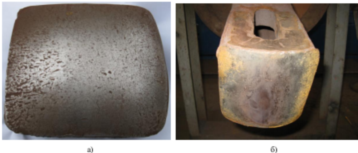
Рисунок 5 – Ударна поверхня хвостовика корпусу автозчепу: а) електровоза ЧС7; б) вантажного вагону
