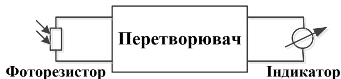
Рис 3.23. Пристрій контролю ступені комутації за рівнем освітленості
