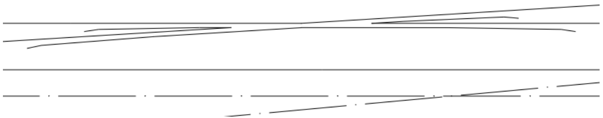
Рисунок 3.14 – Схематичне зображення тупої хрестовини
