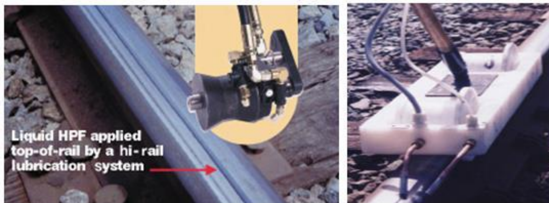
Рисунок 1.7 – Рідкі модифікатори тертя Centra с HPF, LCF та пристрої для їх нанесення: ліворуч – Centra с HPF, праворуч – Centra с LCF
