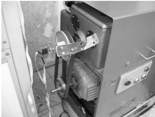
Рисунок 2.4 – Модернізована установка тертя СМЦ-2
