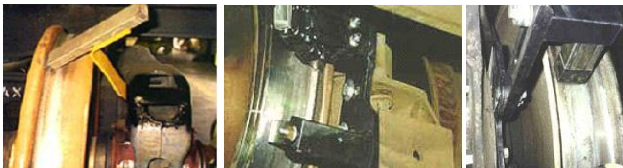
Рисунок 1.6 – Модифікатори тертя VHPF, HPF, LCF
