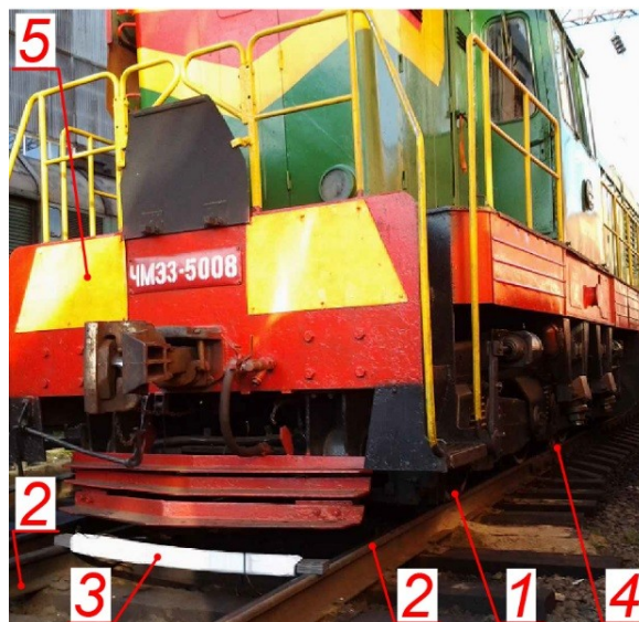
Рисунок 5.4 – а) - схема випробувань; б) - підготовчий етап випробувань: 1 – шоста колісна пара; 2 – рейка; 3 – індукторний пристрій збільшення зчеплення коліс з рейками; 4 – гальмівний черевик; 5 – тепловоз ЧМЕЗ
