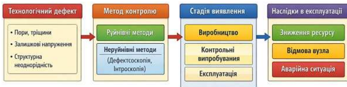
Рис. 12.7. Узагальнююча схема впливу технологічних дефектів на наслідки в експлуатації виробів
