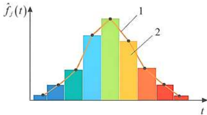
Рис. 11.6. Гістограма (2) і полігон (1) відносних частот інтервального варіаційного ряду
