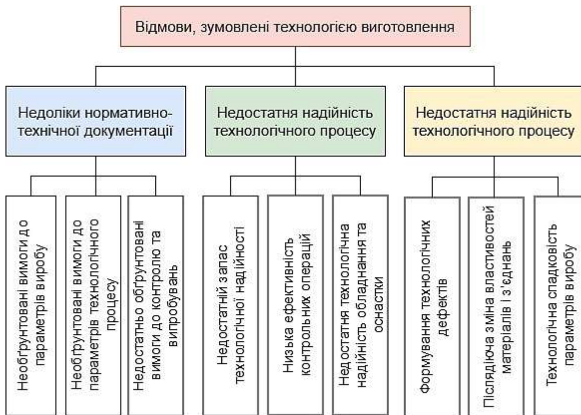
Рис. 12.4. Класифікація відмов, зумовлених недосконалістю технологічних процесів
