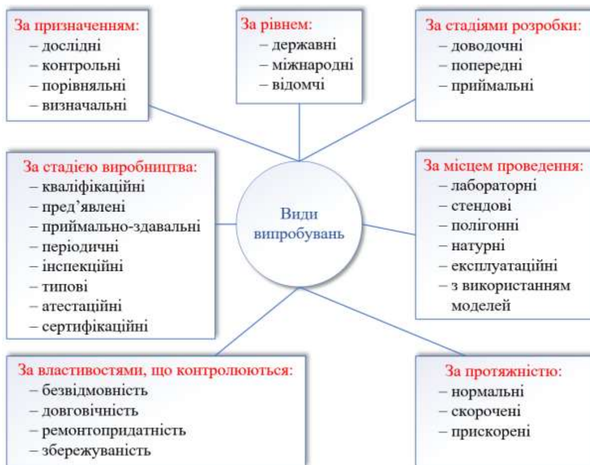
Рис. 11.1. Схема класифікації випробувань на надійність
