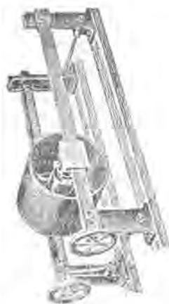
Фиг. 115. Двухшпindelное натяжное приспособление с направляющими прямо-угольного сечения.
