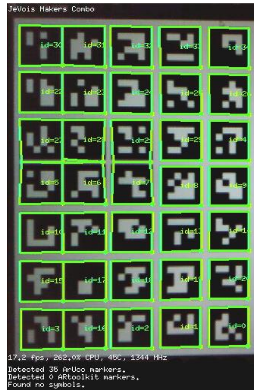
Рис. 7. Одночасне сканування 35 маркерів ArUco
