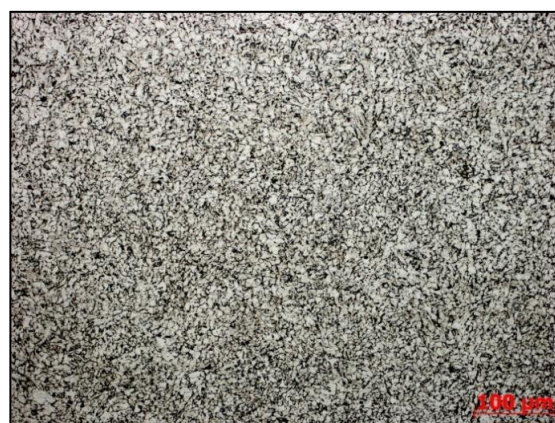
Мал. 5 – Структура зварного шва, зразок №2: а – ділянка перегріву, б – ділянка нормалізації
