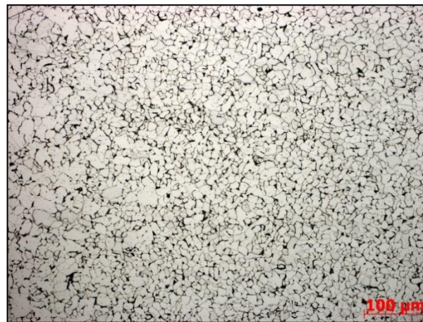
Мал. 7 – Структура зварного шва, зразок №3: а – ділянка перегріву, б – ділянка нормалізації
