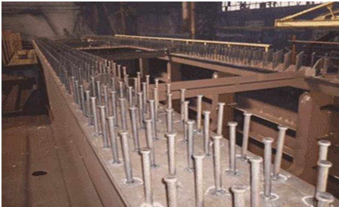
Рисунок 1.11. Анкера приварені напівавтоматичним методом
