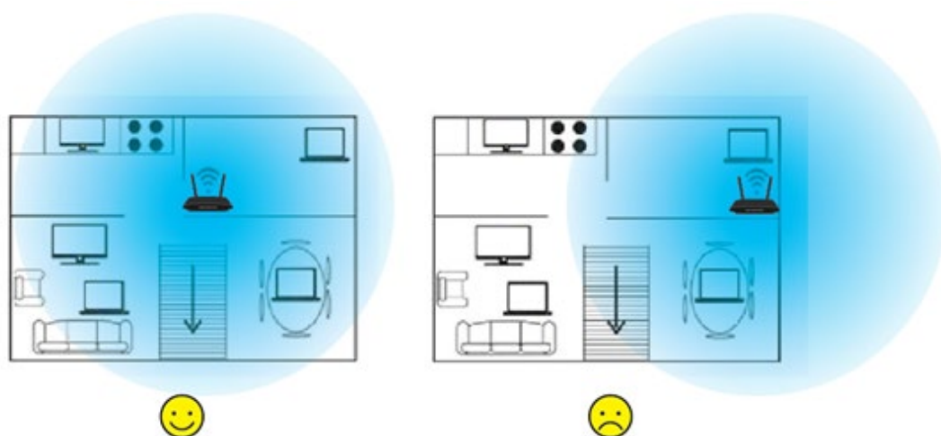
Рисунок 1.3 – Приклад оптимального та невдалого місця розташування точки доступу [6]
