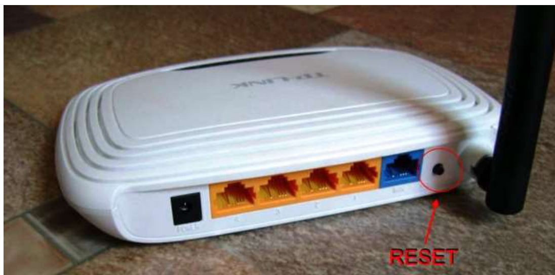
Рисунок 1.2 – Кнопка Reset на точці доступу TL-WR740N
