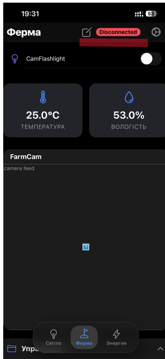
Рисунок 3.7 – Реакція системи на втрату з'єднання з сервером
