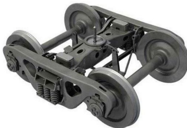
Рисунок 19 – Візок моделі 18-9810 (Barber S-2-R)
