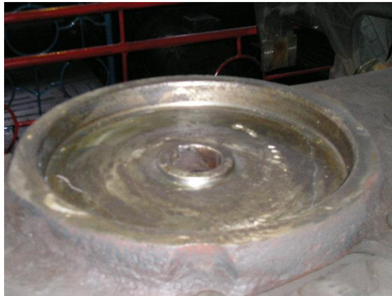
Рисунок 8 – Підп'ятник, який є опорою для кузова
