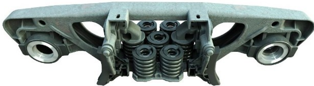
Рисунок 6 – Загальний вигляд бокової рами з внутрішньої сторони
