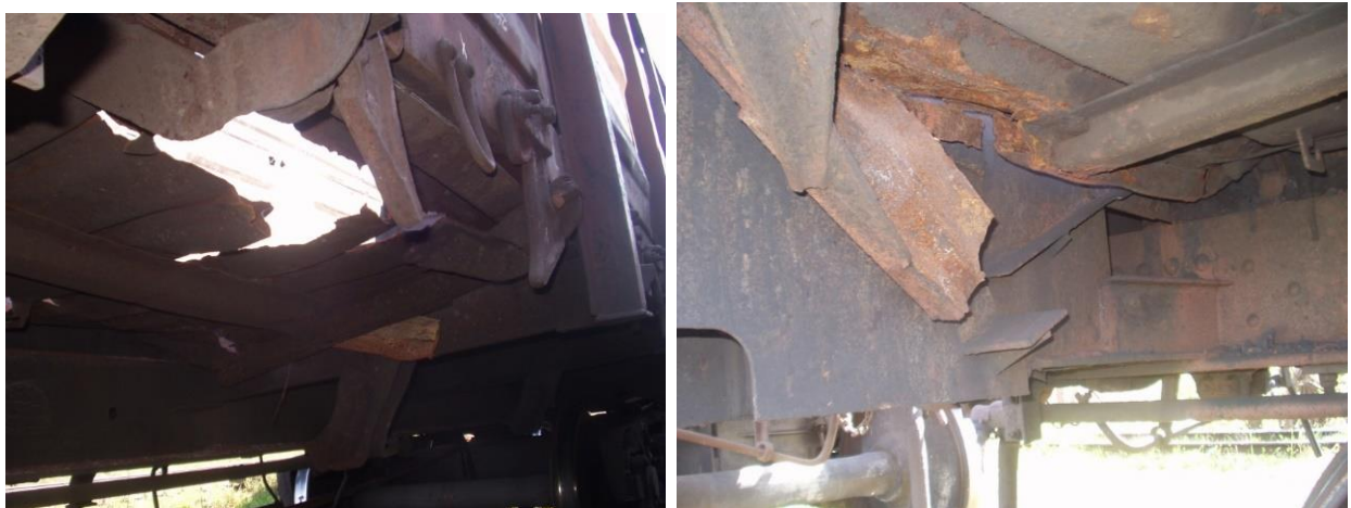
Рисунок 3 – Ушкодження вагонів от грейферного екскаватора
