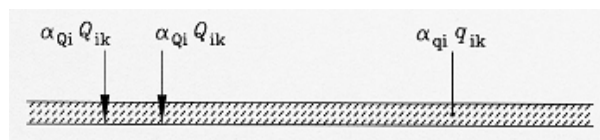
Рис. 1. Продольная схема нормативной западноевропейской нагрузки LM1 (EUROCODE 1 EN 1991-2:2003: The European standards for structures, 2003)
