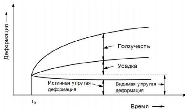
Рис. 7. Зависящие от времени деформации бетона
