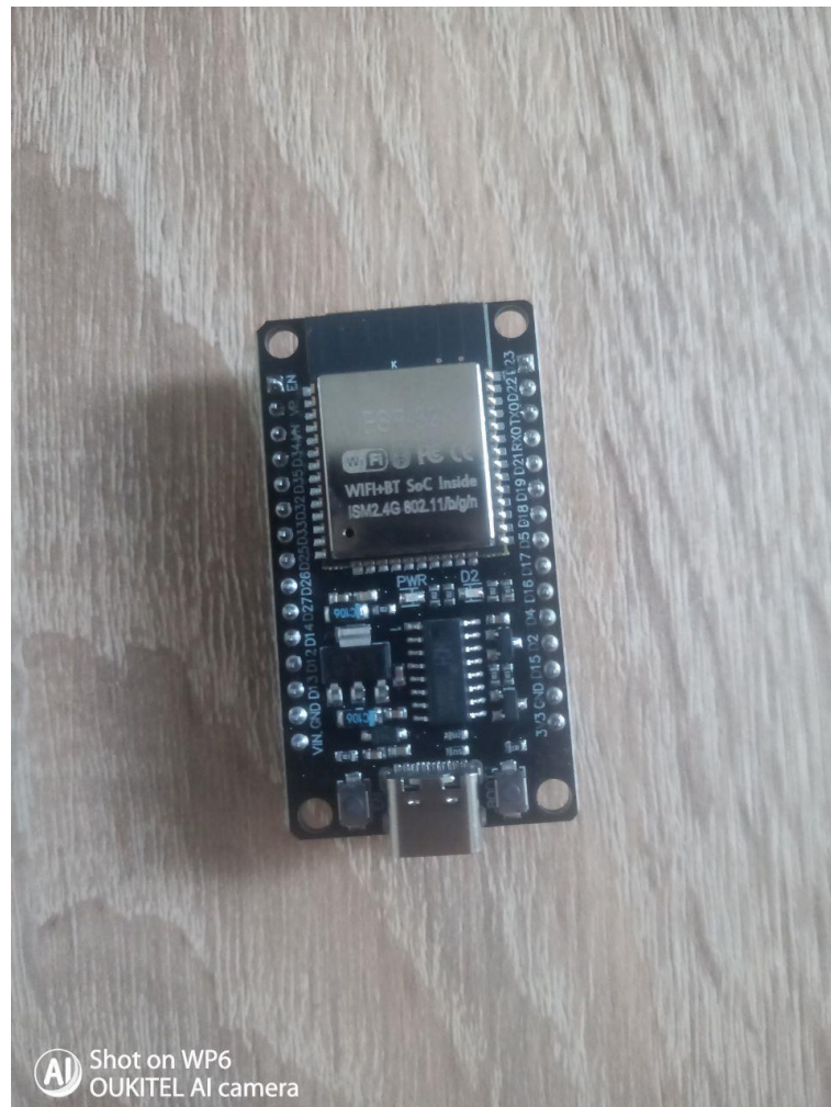
Рисунок 1.7 – Модуль ESP32 DevKit з вбудованим Wi-Fi/BT SoC (ISM 2.4G 802.11b/g/n)
