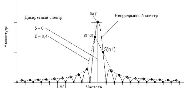
Рис. 1. Формирование дискретного спектра синусоидального сигнала, ограниченного во времени, при дробном и целом соотношениях между длительностью реализации и периодом сигнала
