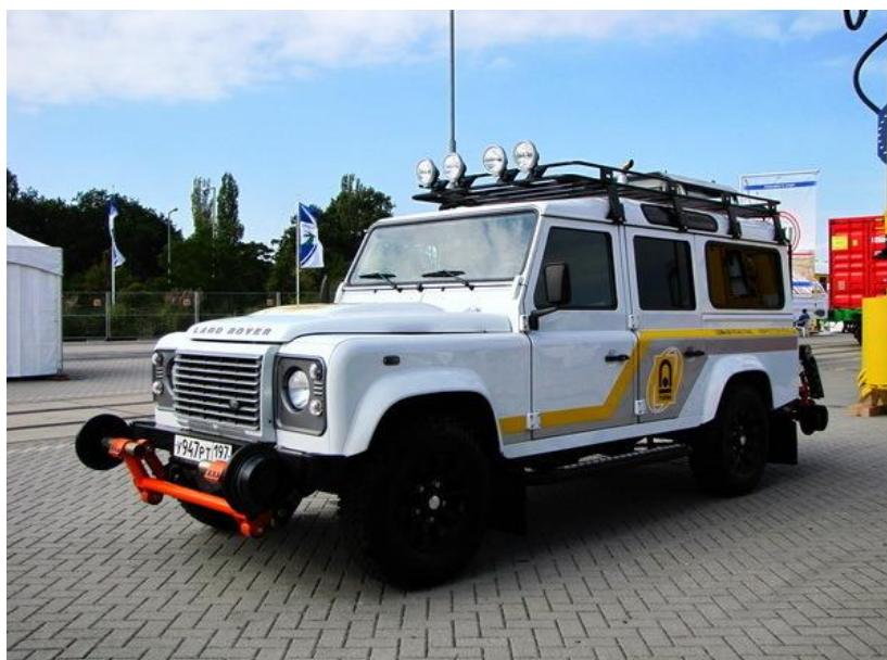
Рис. 2.1 - Колієвимірювальна лабораторія на комбінованому ході LAND ROVER – Defender (ЛДМ-ЛР)
