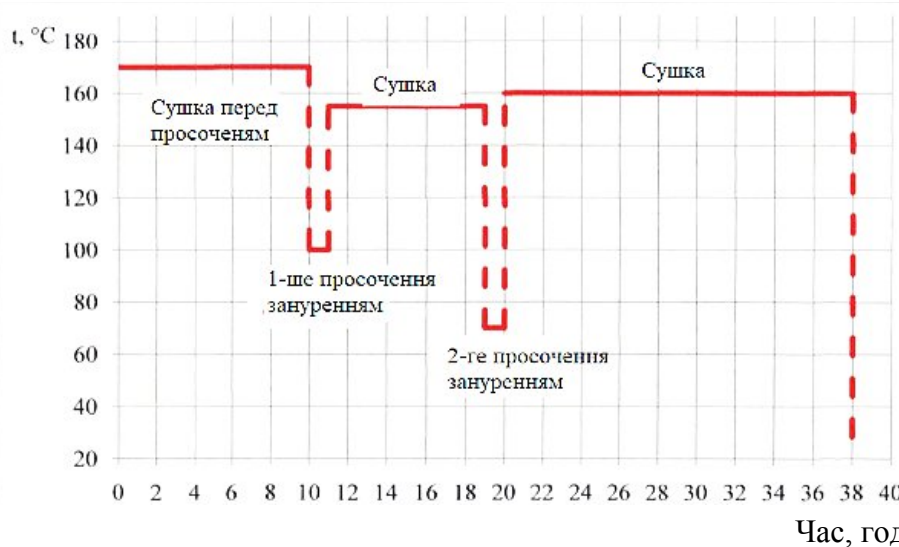
Рисунок 1– Діаграма сушки, просочення і термообробки вузлів ТЕД, просочених в лаку ФЛ-98
