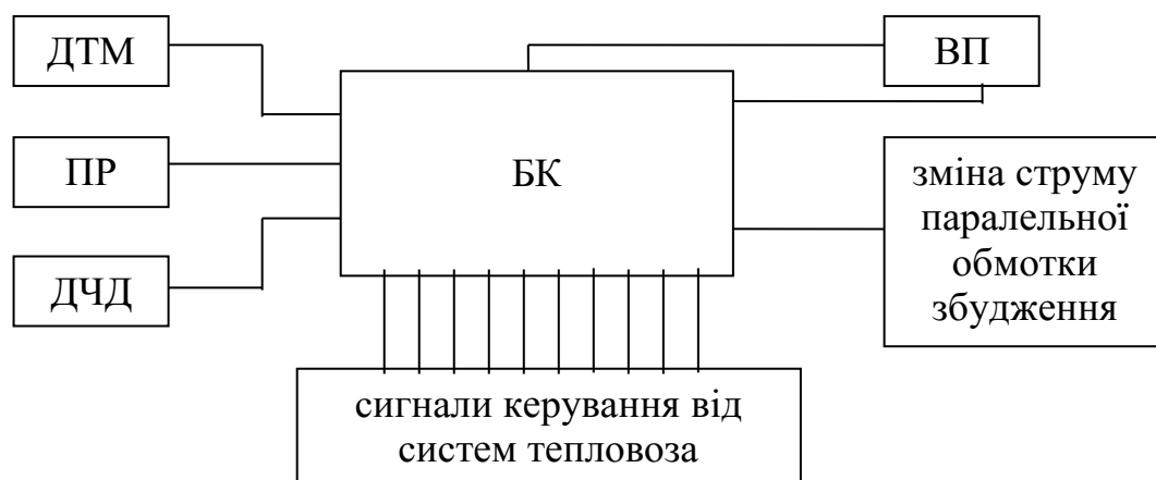
Рисунок 2.1 - Структурна схема електронного регулятора частоти обертання та потужності дизеля K6S310DR
