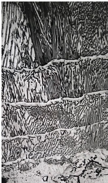
Рисунок 1 – Микроструктура диффузионного слоя образца стали X20, науглероженного в вакууме при термоциклировании с амплитудой от 950 °С до 1050 °С (4 цикла), общее время науглероживания – 70 минут; x400
