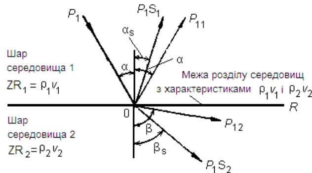
Рисунок 2. Схема утворення відбитих і проходящих хвиль при дослідженні двошарового будівельного матеріалу чи наявності площини розшарування у монолітному бетоні:
