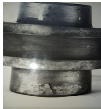
Рисунок 2 - Знос роликів і опорних планок
