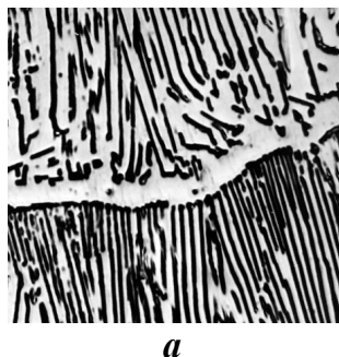
Рисунок 2 – Структурные изменения на фронте роста аустенитно-карбидных колоний при понижении температуры в процессе науглероживания:
