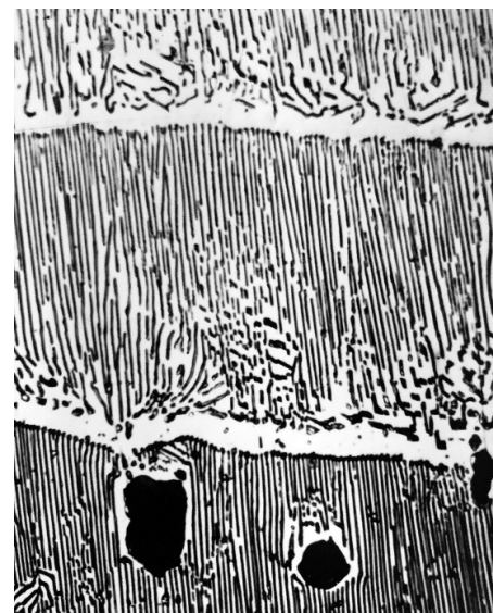
Рисунок 3 – Структурные изменения на фронте роста аустенитно-карбидных колоний при термоциклировании; х630
