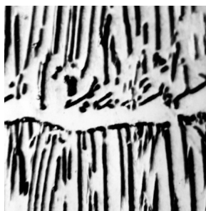
Рисунок 2 – Структурные изменения на фронте роста аустенитно-карбидных колоний при понижении температуры в процессе науглероживания:
