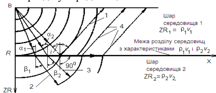
Рисунок 3. Схема утворення переломлених хвиль при дослідженні двошарового будівельного матеріалу чи наявності площини розшарування у монолітному бетоні:
