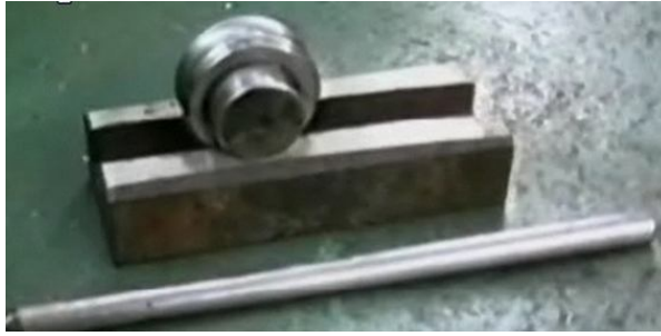
Рисунок 1 - Зовнішній вигляд інструменту стану ХПТР [2]
