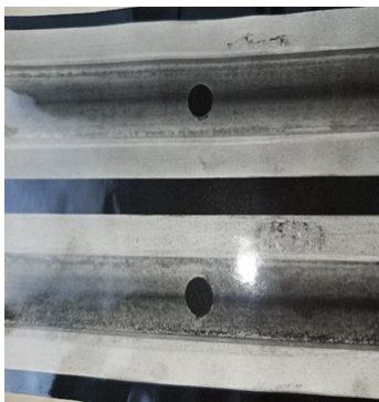
Рисунок 2 - Знос роликів і опорних планок
