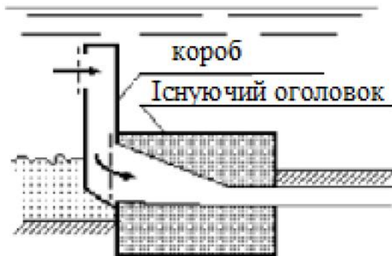
Рисунок 2.7 – Реконструкція оголовка з метою збільшення висоти порога
